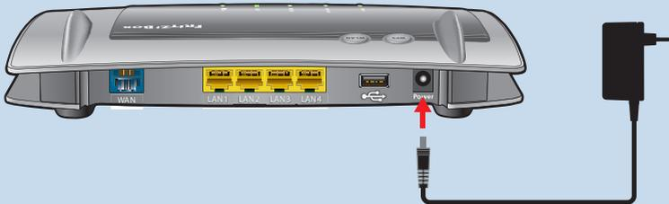
3. Stecken Sie das Netzteil in eine Steckdose.
